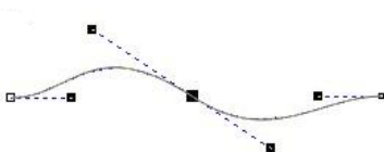
圖 7：運用控制點建立曲線
