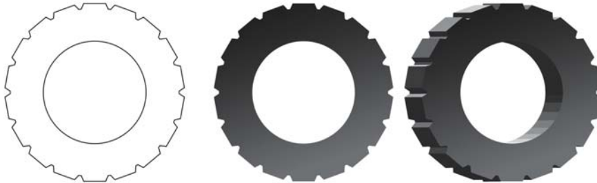
Obrázek 8: Lichoběžníky a vnější kruh jsou sloučeny a poté zkombinovány s malým kruhem za účelem vytvoření plochého, čelního pohledu. Na tvar se použije přechodová výplň a vysunutí.
