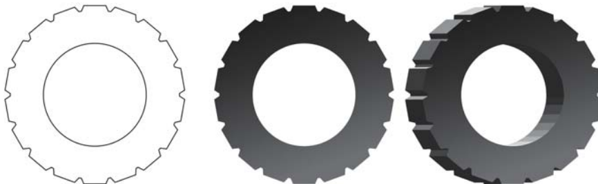
Abbildung 8: Die Trapezoide und der äußere Kreis werden verschmolzen und dann mit dem kleineren Kreis kombiniert, um die flache Vorderansicht zu erzeugen. Der Form werden eine Verlaufsfüllung und eine Extrusion zugewiesen.
