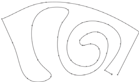
Abbildung 8: Dies ist ein Objekt mit einem offenen Pfad. Es kann keine Füllung annehmen. Die beiden Knoten in der unteren rechten Ecke müssen verbunden werden, um den Pfad zu schließen.
