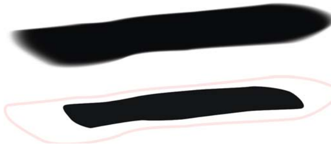
Figura 16: l'immagine superiore mostra l'ombra effettiva. L'immagine sotto mostra due oggetti che, quando fusi, compongono l'ombra. Entrambi gli elementi dispongono dello stesso numero di nodi e di una posizione del nodo simile, quindi l'ombra risulta uniforme lungo i bordi. Se l'ombra non appare uniforme, controllare di nuovo i nodi.
