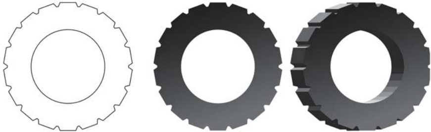
図8: 台形と外側の円がウェルドされ、小さいほうの円と結合されて、正面のフラットビューが作成されました。グラデーション塗りつぶしと押し出しが形状に適用されました。
