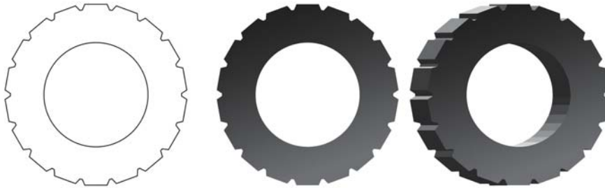
Afbeelding 8: De trapezoiden en de buitencirkel worden aan elkaar gelast en vervolgens gecombineerd met de kleinere cirkel om het platte vooraanzicht te krijgen. Op de vorm worden daarna een verlooptintvulling en 3D-effect toegepast.
