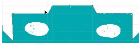
Afbeelding 28: De knooppunten slepen zodat de kromme de buitenrand van de gescande doos volgt
