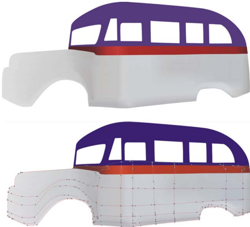
Rysunek 12: Nakładanie wypełnienia siatkowego na główną część nadwozia.
