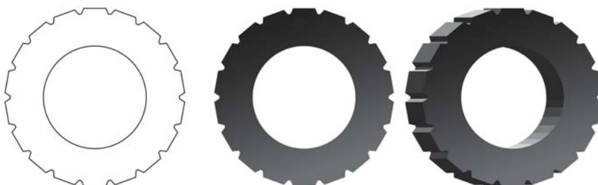
Рис. 8. Трапеции припаиваются к внешней окружности, после чего получившийся объект объединяется с меньшей окружностью, чтобы получился плоский вид спереди. К форме применяются эффекты градиентной заливки и вытягивания.
