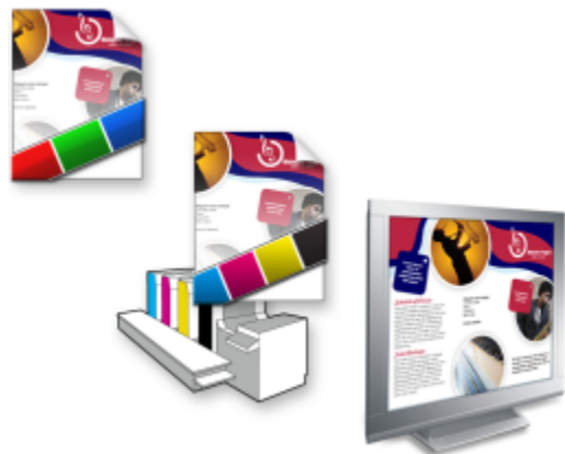
左上：已将 RGB 颜色预置文件指定到文档。中间和右边：指定一个特定的 CMYK 预置文件可允许在屏幕上模拟打印的输出。
