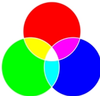
Le blanc résulte de la combinaison des trois couleurs RVB à leur intensité maximale.
