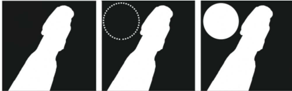
une composante alpha (1), une composante alpha affichée avec le masque courant (2), le masque est ajouté à la composante alpha (3)
