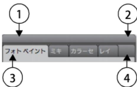
標準的なパレットには、ヘッダー バー (1)、パレットをパレット引き出しに変換できる [パレット引き出し] ボタン (2)、パネルタブ (3)、関連する一連のコマンドにアクセスできるパネル オプション (4) があります。
