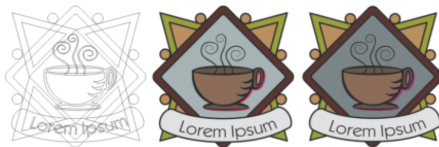
Mode d'affichage Fil de fer (à gauche) ; mode d'affichage Amélioré (au centre) et mode d'affichage Simulation de surimpressions (à droite). Une surimpression a été définie pour la surface du losange gris et l'ombre de la tasse.
