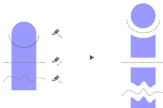
(从上到下) 提供三种对象拆分模式：贝塞尔曲线、2 点线和手绘线。
