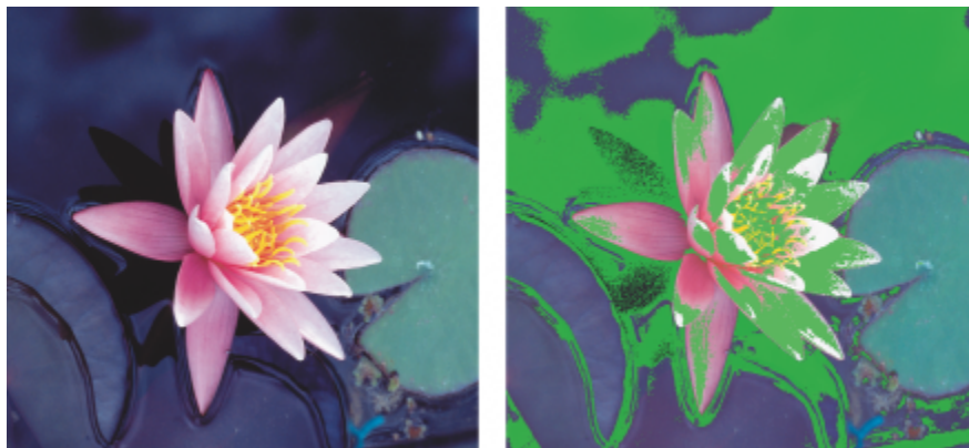
色谱警告会突出显示打印机或监视器不能准确再现的颜色。
